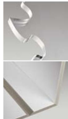
Spezielle Fräsfunktionen (z.B. für Acryl) ergeben „fast polierte“ Kanten. Eine spezielle Kompensationsfunktion garantiert auch bei Wellpappe, Schaumplatten, etc., sauber geschnittene Ecken ohne sichtbaren Überschnitt.
